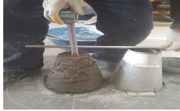
Şekil 4. Çökme (slump) deneyi
