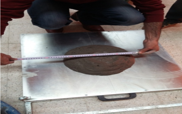
Şekil 3. Yayılma tablası deneyi
