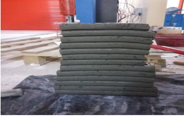
Şekil 2. Beton harç baskı
