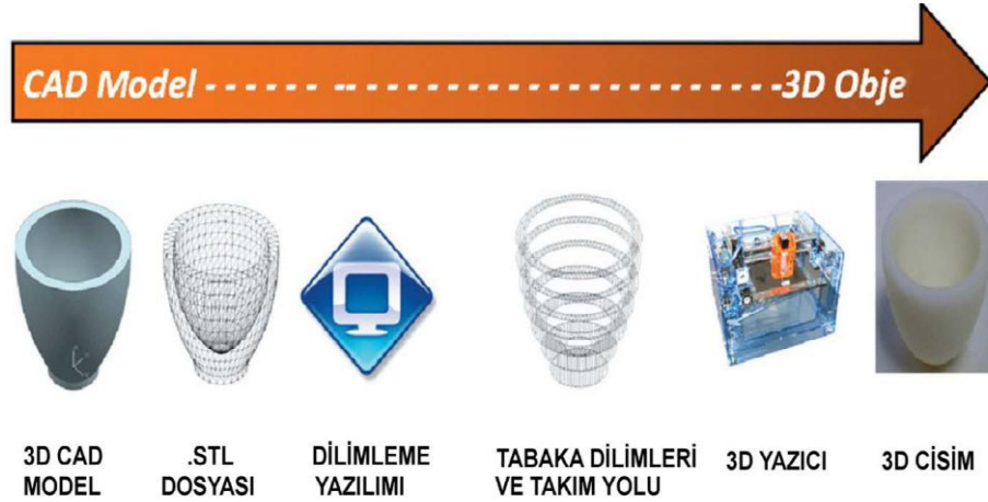
Şekil 2.5. Bir 3D CAD modelin katmanlı üretim süreci (Campbell, 2011).
