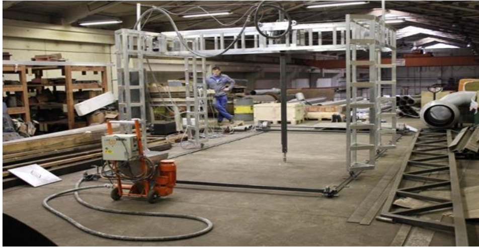
Şekil 3.2. Üç boyutlu beton yazıcı cihazı (yhbm, 2016).
