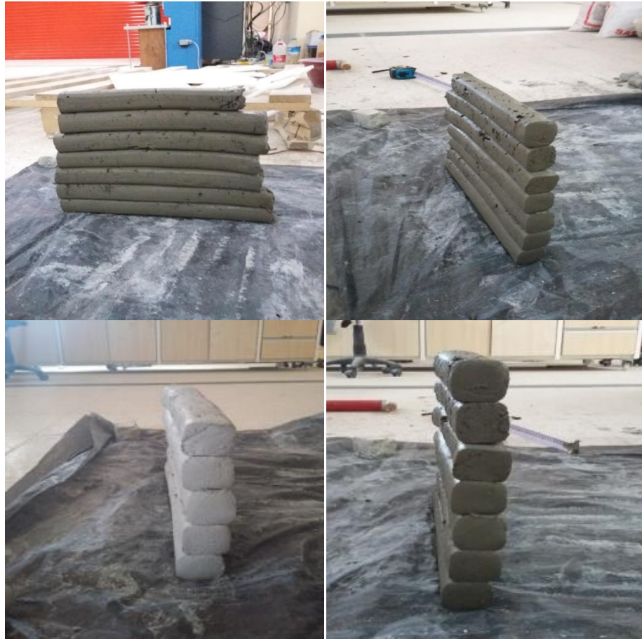
Şekil 6.4. Pompa sistemi ile yapılan örnek beton baskılar.
