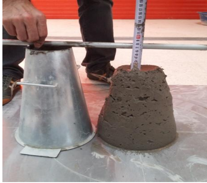
Şekil 6.6. Beton harç çökme deneyi.
